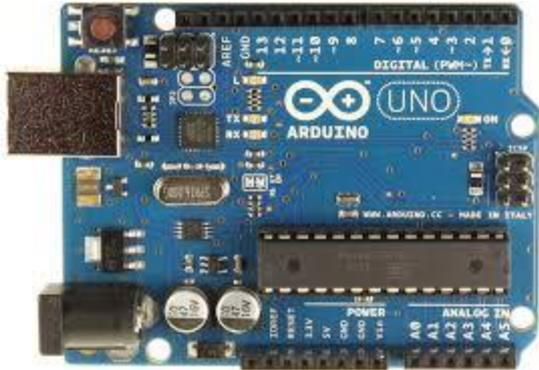
Esta plataforma puede detectar o afectar el entorno recibiendo entradas de diversos sensores y activando algunos actuadores respectivamente. La tarjeta Arduino posee un micro controlador el cual se programa mediante el lenguaje de programación Arduino y el entorno de desarrollo Arduino.
