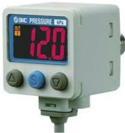
Cuenta con tres terminales, una de alimentación de 12 VDC a 24 VDC, la otra para conexión a tierra y una ultima que funciona como salida analógica, siendo esta ultima la que esta sensando la tarjeta Arduino.
