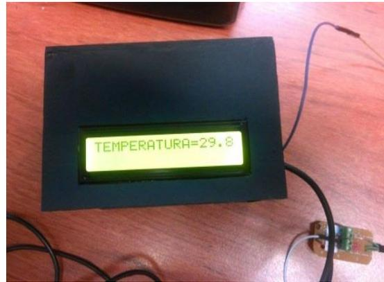
Al sistema discontinuo, tipo batch utilizado se le agrego un sensor de temperatura en el reactor para ayudar al usuario a conocer la temperatura y si así lo desea controlar dicha temperatura para ayudar a la descomposición anaeróbica que se genera, en la figura se muestra el display utilizado para medición de la temperatura en el reactor.
