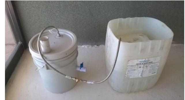
La descomposición anaeróbica se mantuvo a una temperatura ambiente de alrededor de los 30 °C , el prototipo del depósito de gas es de tipo campana flotante, en donde con dos depósitos ( porrones ) uno dentro del otro, se formara el deposito campana con sello de agua, esta sencilla instalación ayuda a estudiar los parámetros de digestión en caso de no contar un medidor de presión montado en el reservorio como se observa en la figura.
